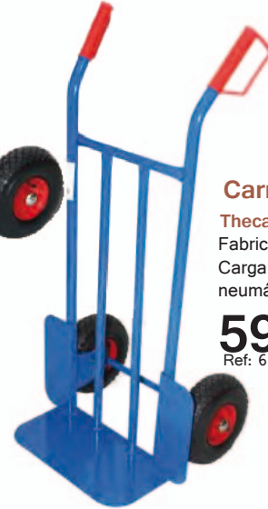
Carro Almacén Theca Fabricada en tubo Ø 30x1,5 mm. Carga 300-350 Kg. Pala abatible. Rueda neumática.
